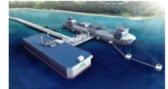
Small scale LNG carrier at import terminal
